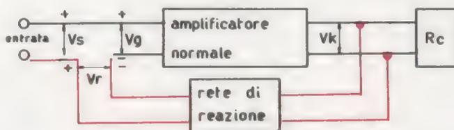
Fig. 4-26 - Schema di collegamento di un amplificatore con reazione di tensione
