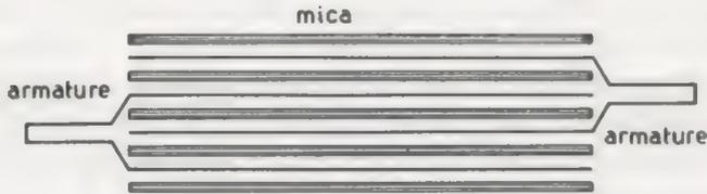
FIG. 2-10 - Condensatore a mica a strati sovrapposti
