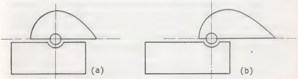
FIG. 2-16 - Forma delle armature mobili di un condensatore a variazione lineare della lunghezza d'onda (a) e a variazione lineare della frequenza (b)
