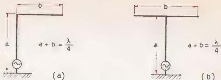
FIG. 11-27 - Antenne collegate a terra: ad L rovesciato (a) e a T (b)
