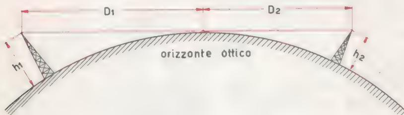
Fig. 11-13 - Propagazione per onde dirette: orizzonte ottico
